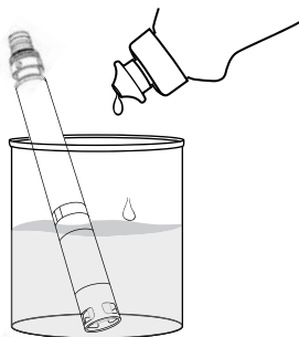
图 72 使用洗洁精清洁 pH 和 pH/ORP 传感器
